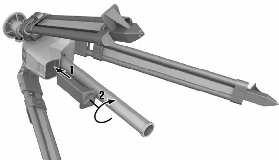
1. バッテリーを三脚の収納部へ挿入します。
