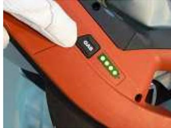
2.残量ゲージボタンを押しガスの残量が十分あることを確認
