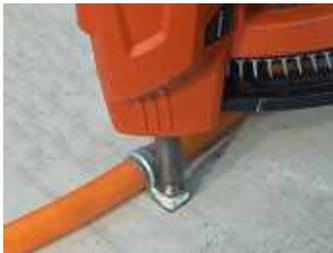
5.本体を打鋏面に強く押し当て密着させ、トリガーを引く
