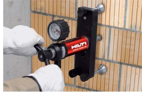
ヒルティ HIT-HY 270 ETA または この技術マニュアルデータに記載のないレンガや中空母材の場合、基準耐力は、ETAG029, Annex B に準拠し、現場載荷試験（引抜け試験や荷重確認試験）によって算出します。
