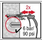
**ハンマードリル穿孔 (HD) の場合: エアコンプレッサーによる清掃 (CAC)** 全ての穿孔径 d<sub>0</sub> および穿孔長 h<sub>0</sub>≤20·d に適用
